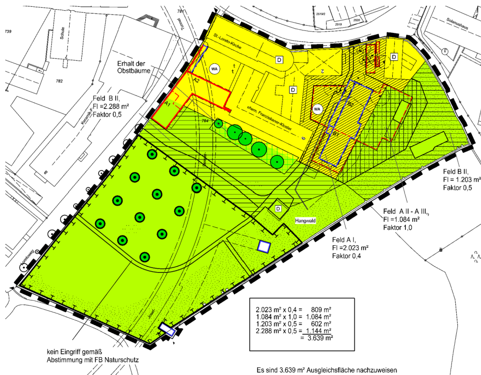
Überlagerung: Gebiete mit unterschiedlicher Bedeutung für Naturhaushalt und Landschaftsbild mit Kategorien und Gebieten unterschiedlicher Eingriffsschwere
