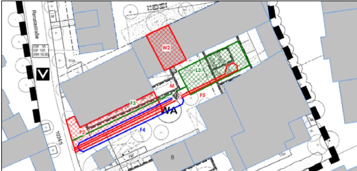
Abbildung 9: Lageplan mit Kennzeichnung der Schallquellen des Motorradhandels
