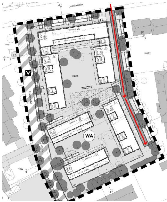
Abbildung 8: Konzept Lage und Führung der Feuerwehrezufahrt im Osten für die beiden Teilbereiche TB 1 und TB 2, unmaßstäblich
