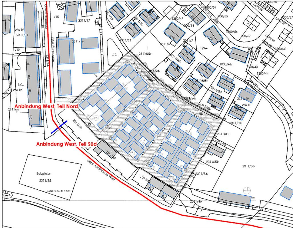
Abbildung 6: Lageplan mit Eintragung der Straßenabschnitte
