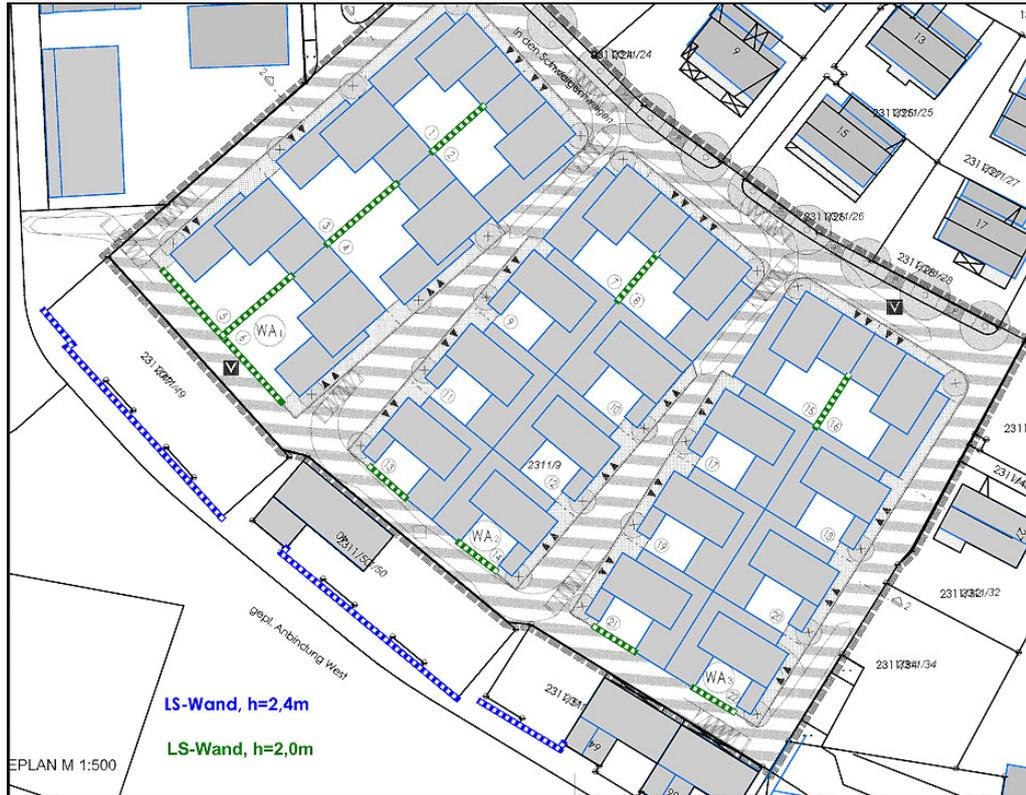
Abbildung 7: Lageplan mit Eintragung der Lärmschutzwände (nicht maßstäblich)
