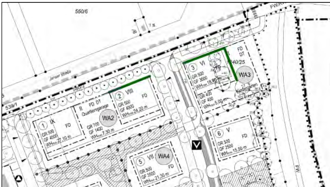
Abbildung 15: Lageplan mit Kennzeichnung der Fassadenbereiche, an denen Immissionsgrenzwertüberschreitungen (auf den jeweiligen Obergeschossen) zur Tagzeit prognostiziert werden
