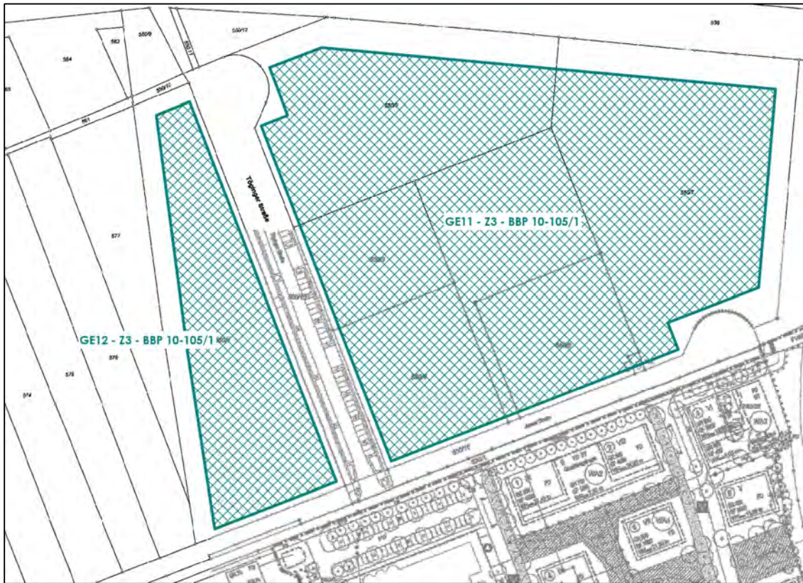
Abbildung 6: Lageplan mit Darstellung der idealisierten Flächenschallquellen zur Ermittlung der anlagenbezogenen Geräuschbelastung im Geltungsbereich der Planung (Bereich Nord)
