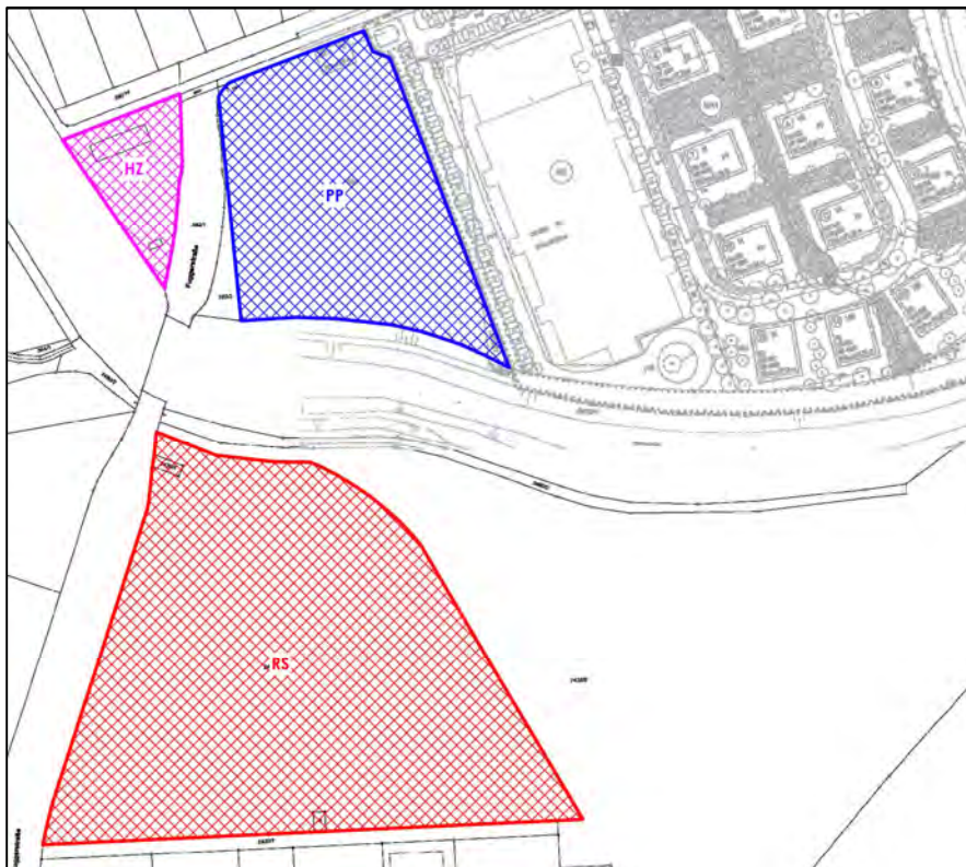
Abbildung 8: Lageplan mit Darstellung der Flächenschallquellen zur Ermittlung der Vorbelastung durch die staatliche Realschule Landshut, dem geplanten Heizwerk und die benachbarte Parkplatznutzung
