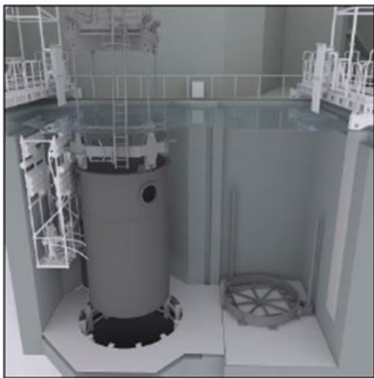
Ausheben des Unteren Kerngerüsts
