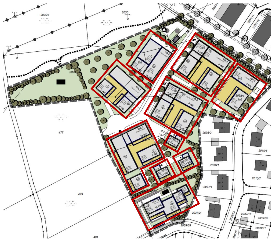
Abbildung 3: Bebauungsplan, Einteilung Wärmecluster=Wohnanlagen
