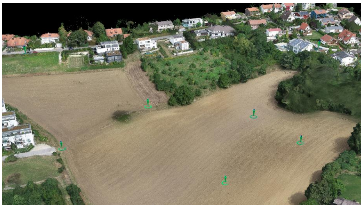
Abbildung 1: Ausschnitt des 3D-Modells „am Steinlech“, mit Lage der Bodenkontrollpunkte
