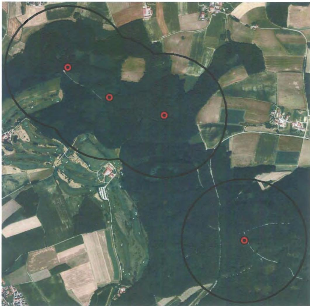
Abbildung 3.1. potenziell geeignete Standorte von Windenergieanlagen im Auswahlbereich „Seligenthaler Klosterholz“ (schwarze Linien: Abstandskreis von 500 m; ungefähre Maßstab: 1 : 17.000)
