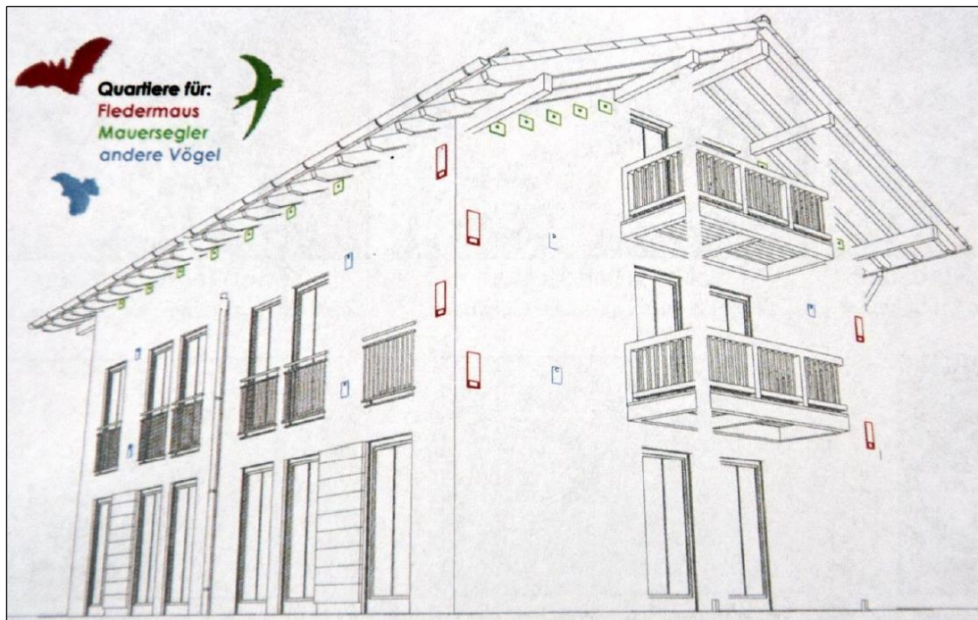
Abb. 7 Unterschlupfmöglichkeiten für Fledermäuse unter einer Abdeckung (Quelle: LBV München)
