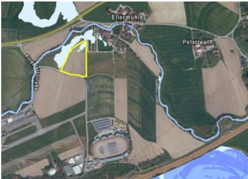
Abbildung 3: Ausschnitt aus BayernAtlas, mit Darstellung der Hochwasserflächen HQ 100 (hellblau) und voraussichtlichen Geltungsbereich für den VBP (gelbe Linie)
