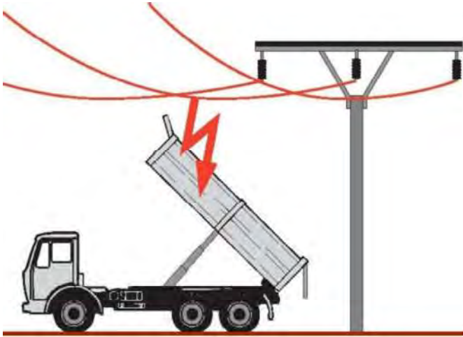
Abbildung 4: Berühren einer 20kV-Leitung beim Entleeren eines LKW's
