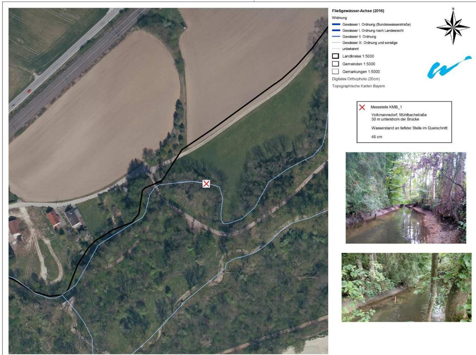
Abb. 34: Lage sowie Charakterisierung Wasserstand-Messstelle KMB\_1 (Quelle: WWA LA)
