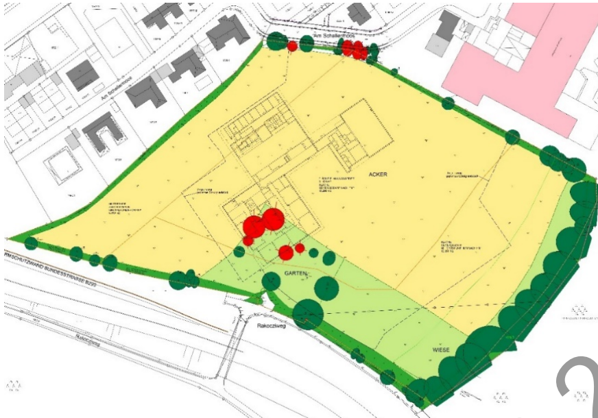
Abbildung 5: Bestandsplan mit Baumbestand, Landschaftsarchitekt Tautorat 2/2020, unmaßstäblich. (grün = verbleibende Bäume, rot = zur Rodung geplant)
