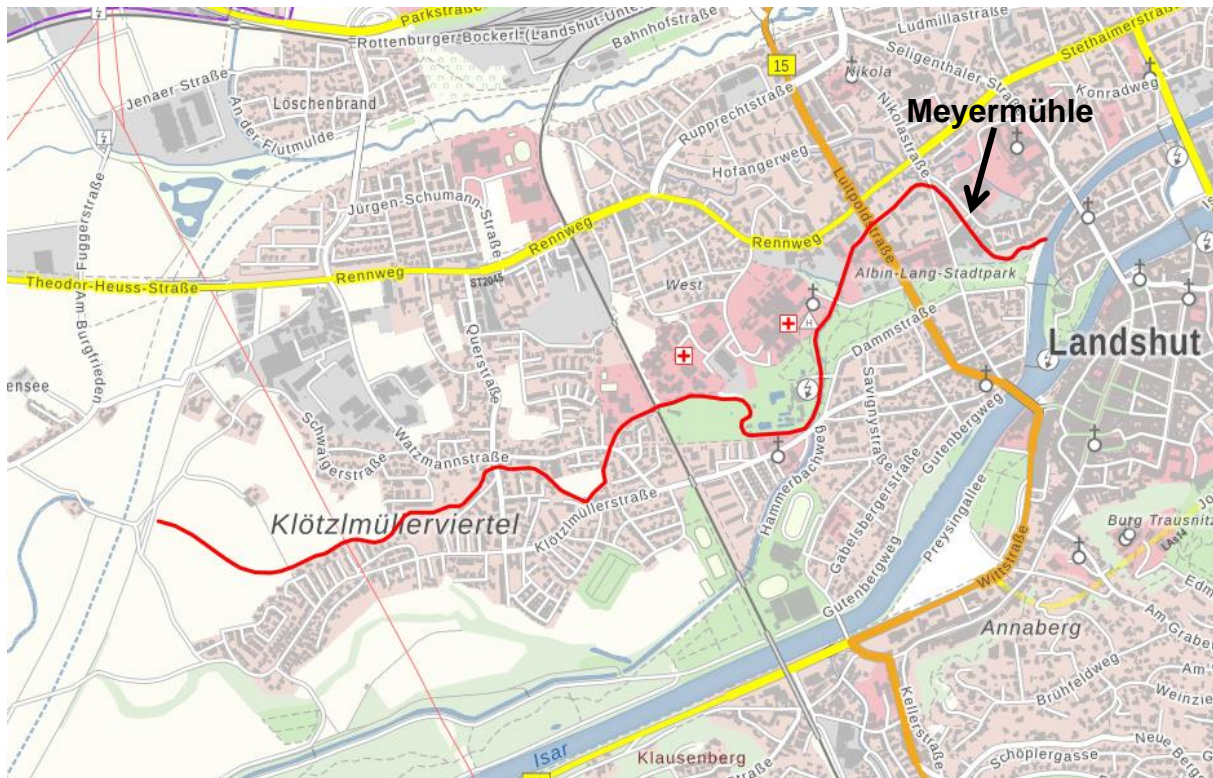
Abbildung 4.10: Anhand von DGM, Bruchkanten und Ortsbegehung modellierter Teil des Klötzlmühlbachs
