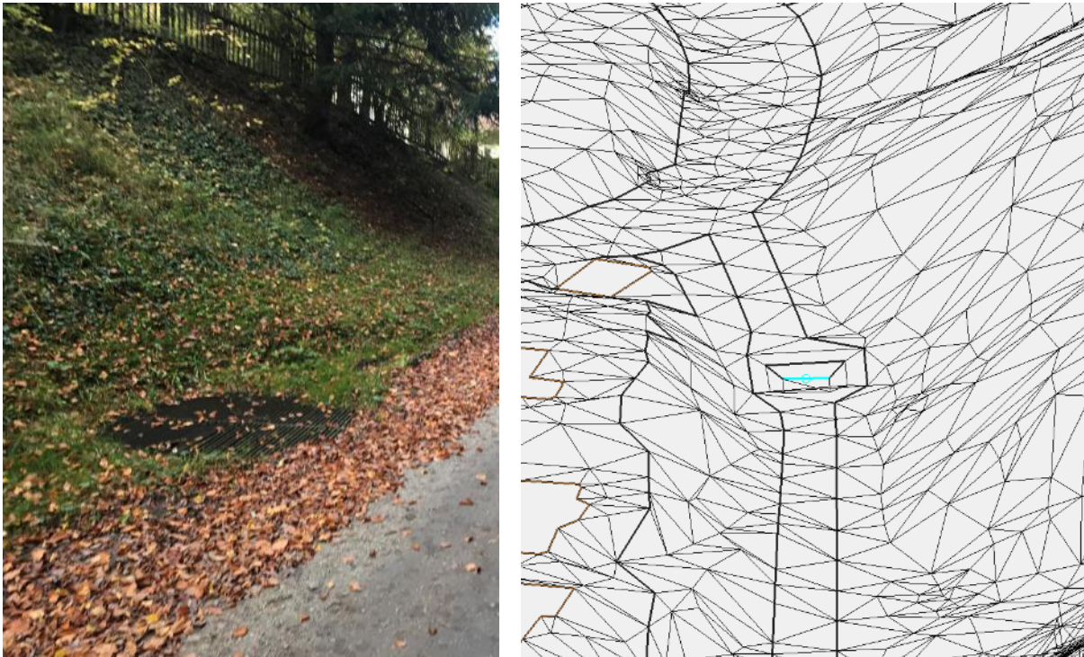
Abbildung 4.18: Kanaleinlauf Rosental, Achdorf (12430R1101) in Realität und Modell
