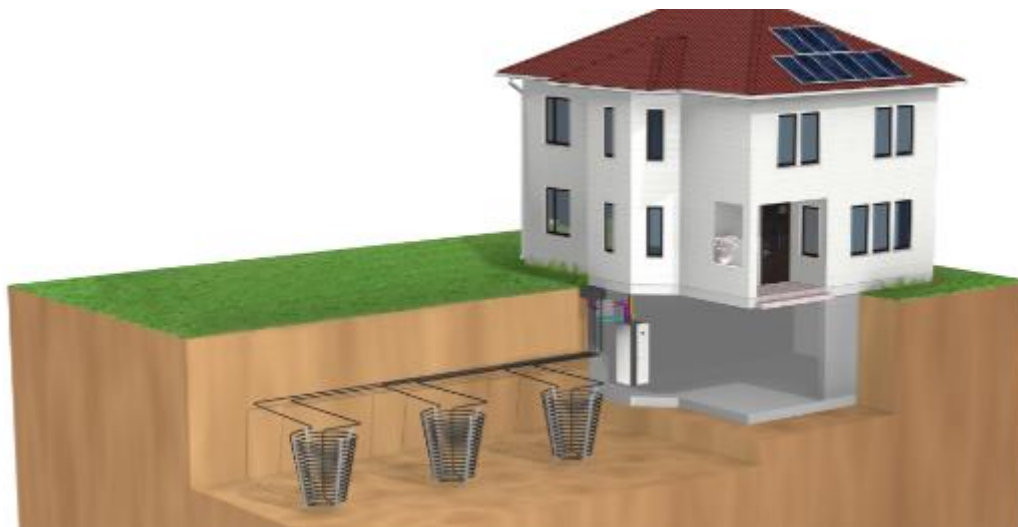
Prinzipbild Energiekörbe Fa. BetaTherm ( https://www.betatherm.de )
